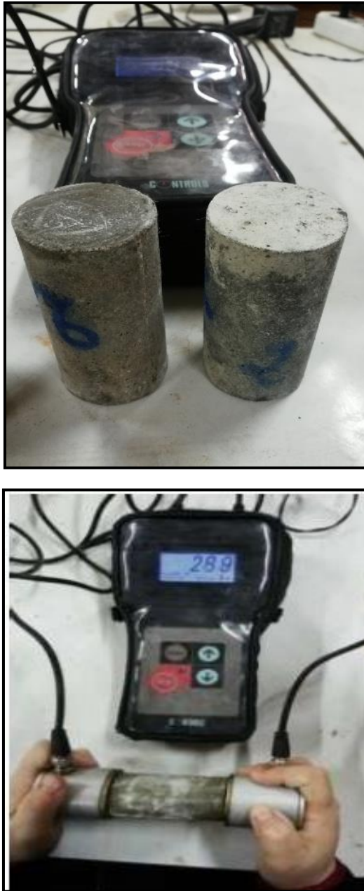
Figure 4.11 – Essai du module d'élasticité dynamique E_D des MAPF s .
