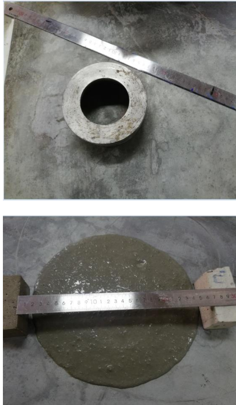
Figure 4.5 – Évaluation de l'étalement des mortiers de réparation à l'aide du mini-cône.
