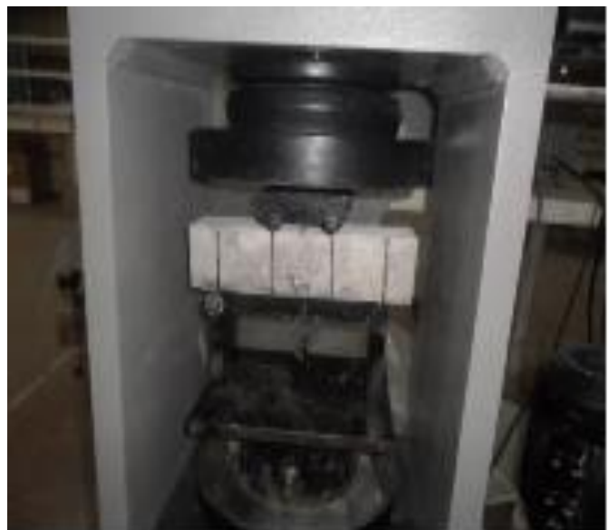
Figure 4.18 – Composites (MAPF 5 -Béton de substrat) sous essai de flexion 4 points.
