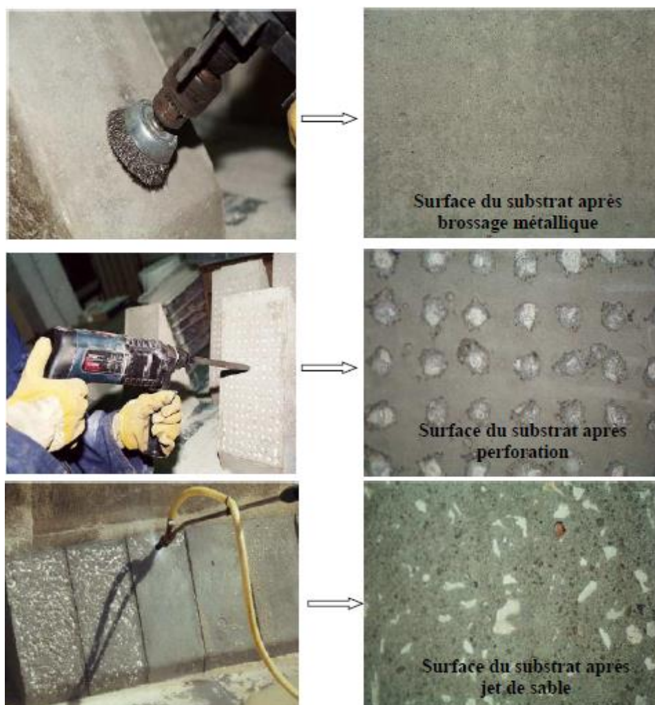
Figure 3.27 – Méthodes de traitement des surfaces employées (Julio et al., 2004).
