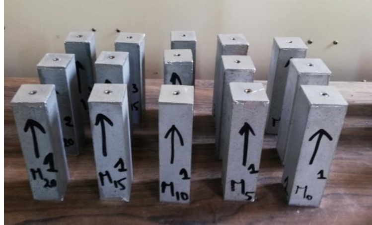
Figure 4.13 – Les éprouvettes ont été réalisées afin de mesurer le phénomène de retrait.
