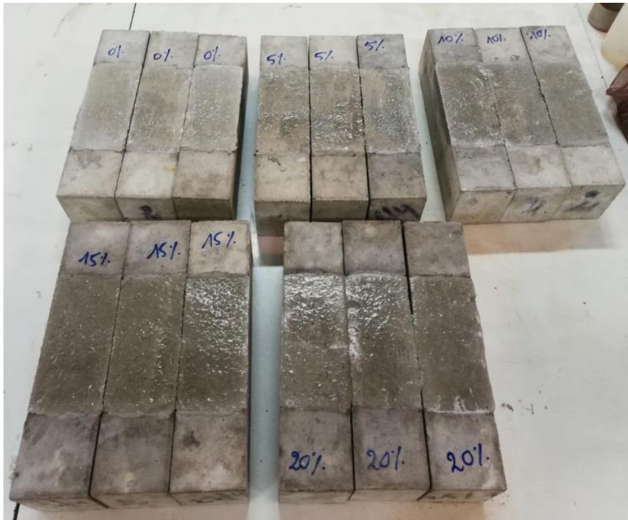
Figure 4.17 – Les mortiers de réparation ont été appliqués pour remplir entièrement les évidements de 1 cm.
