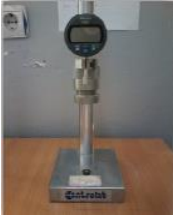
Figure 4.12 – Rétractomètre pour la mesure du retrait des MAPFs.
