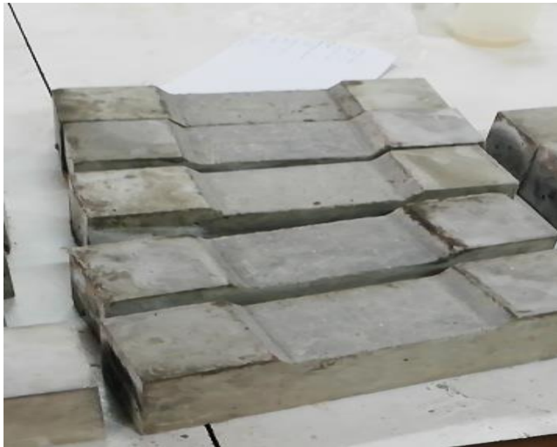
Figure 4.16 – Un échantillon prismatique avec évidement servant de substrat.
