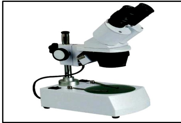
Figure II.6. Microscope optique binoculaire pour le choix du monocristal.
